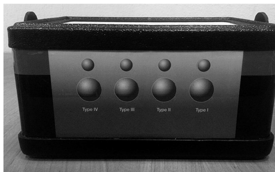
Рис. 2б. Калиброванный полимерный фантом CIRS Model 049A Elasticity QA Phantom Spherical
