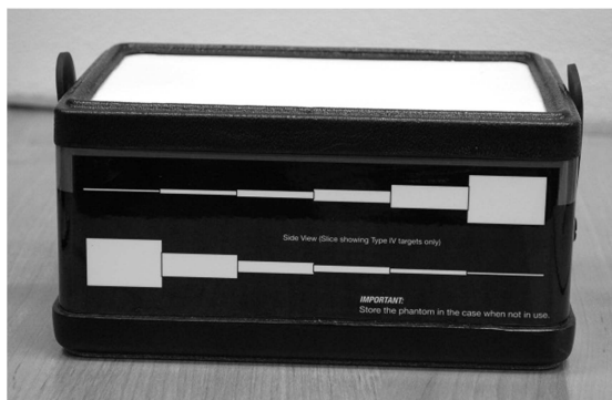
Рис. 2а. Калиброванный полимерный фантом CIRS Model 049A Elasticity QA Phantom Stepped Cylinder
