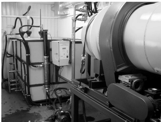
Рис. 4. УЗ гальванокоагуляционной комплекс очистки загрязнённых вод позволяет в 2-3 раза сократить количество используемого реагента, а значит и количество получаемого осадка.
