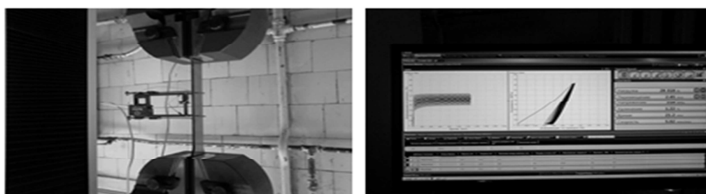
Рис. 1. Образец в захватах испытательной машины Tinius Olsen Ltd, модель H100KU при проведении циклических испытаний.
