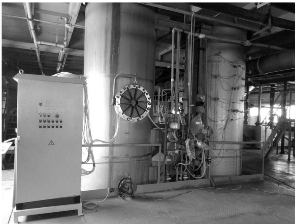
Рис. 1 - Установленные на колонне в зоне десорбции УЗ излучатели
