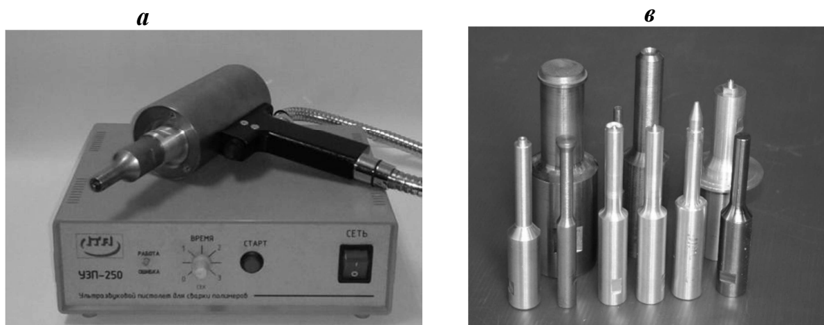
Рис. 1. Внешний вид аппарата для ультразвуковой сварки термопластичных полимеров (а) и излучателей с различной формой сварочных наконечников (б)
