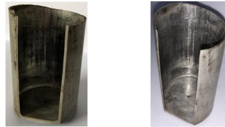
Рис. 3 - Стаканчики, полученные в результате обратного выдавливания
