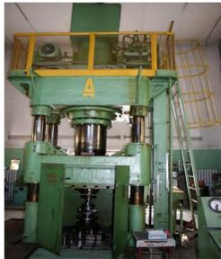
Рис. 1 - Гидравлический пресс марки ДБ-2240
