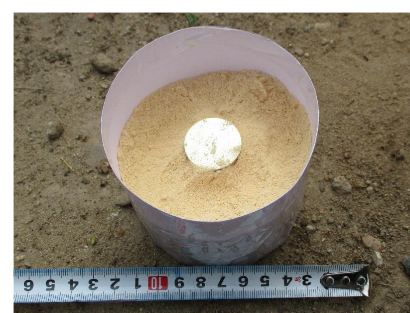
Рисунок 2. Схема эксперимента по обжатию образца скользящей детонационной волной.
