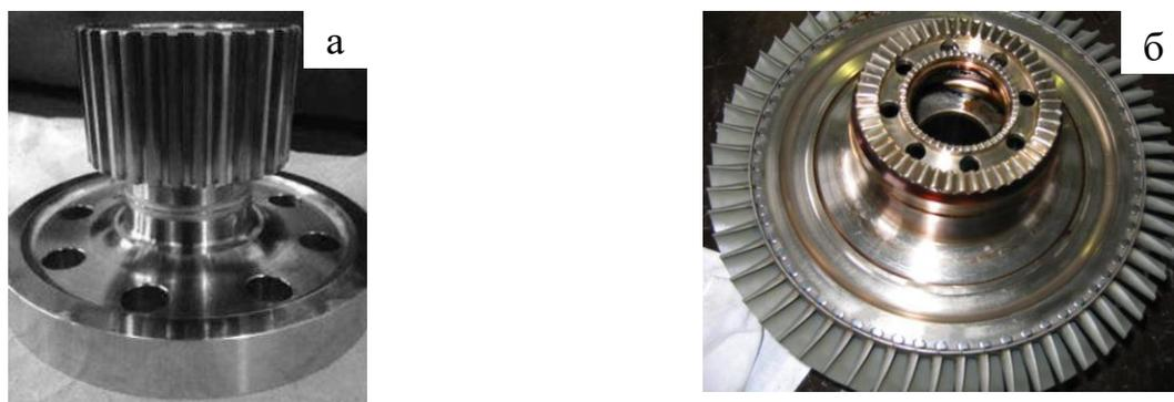
Рисунок 1.14 – Сварной роторный блок из сплава ВЖ172 [102] конструкции АО «Климов» (а) и образец-демонстратор конструкции типа «БЛИСК» (б) [100]
