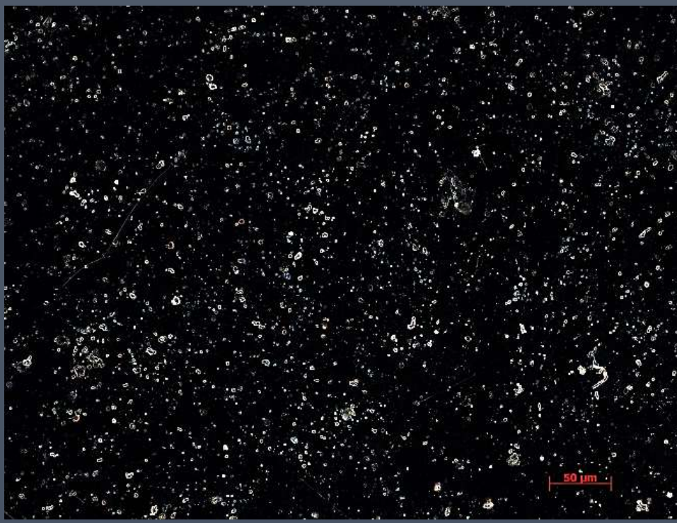
РИСУНОК 2. Структура образцов сплава Ti49.0 Ni51.0 на инвертированном микроскопе: (а) крупнозернистое состояние (б) ультрамелкозернистое состояние; темное поле
