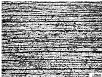
Рис.1 – Исходная структура стали 14Г2 (светлая фаза – феррит, темная – перлит)
