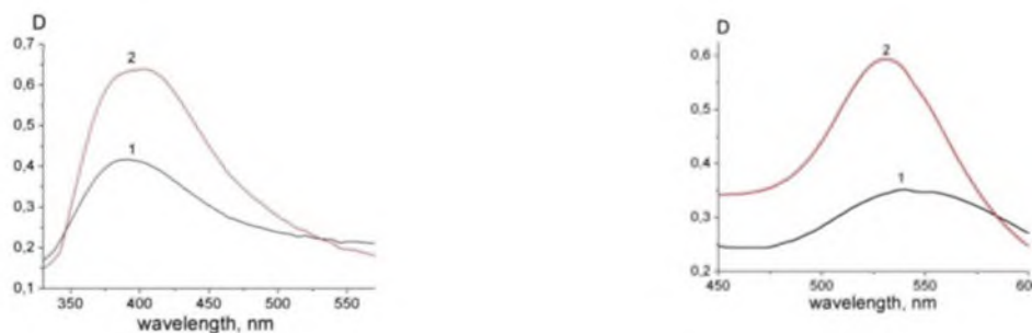
а) б) 1- C_{Ag}=6 \cdot 10^{11} моль/м 2 ; 2- C_{Ag}=2 \cdot 10^{13} моль/м 2 . 1- C_{Au}=2 \cdot 10^{12} моль/м 2 ; 2- C_{Au}=7 \cdot 10^{13} моль/м 2 .
