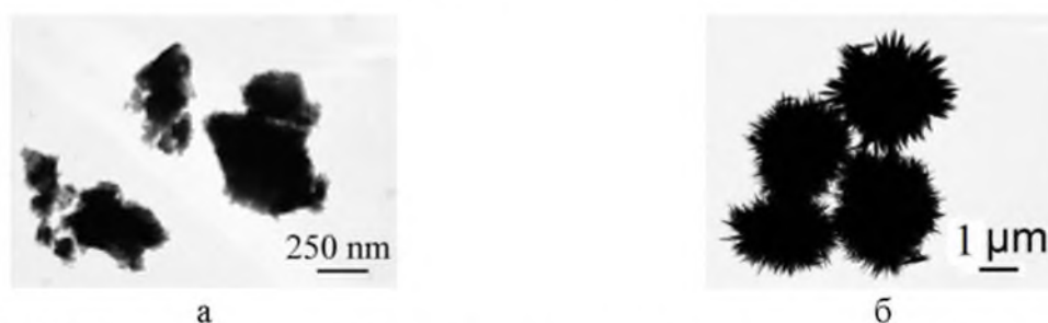
Рис. 1. ПЭМ изображения оксида железа: а - полученного осаждением из раствора соли; б - гидротермальное окисление.
