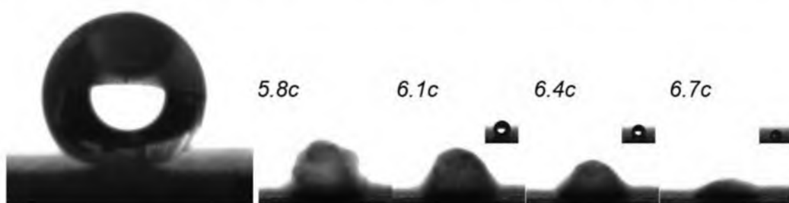
Рис. 2. Капля воды на поверхности графенового нанокompозита в режиме Лейденфроста (а), нарушение стабильности левитации (б)
